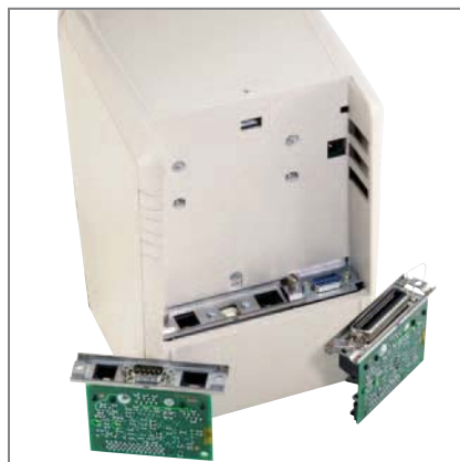
AUSTAUSCHBARE SCHNITTSTELLEN Seriell, Parallel, USB und LAN
